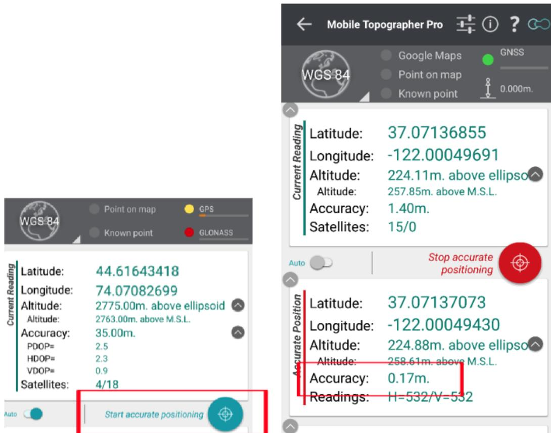
4. Cuando ya queremos guardar el punto, presionamos el botón en rojo “**Stop accurate positioning**” y presionamos (como se puede ver en la
